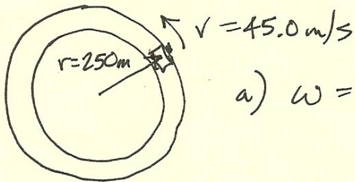
$$\text{a) } \omega = \frac{v}{r} = \frac{45\text{ m/s}}{250\text{ m}} = 0.18\text{ s}^{-1}$$
